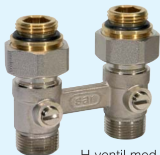
H-ventil med avstengning. For integrert ventilsett. C/C 50, anslutning M22 Art.nr. 529008
